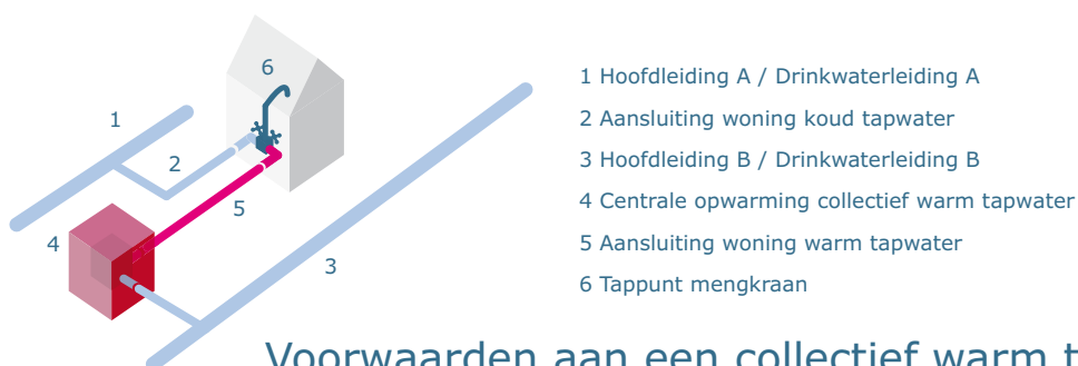
Figuur 2 | Centrale opwarming collectief warm tapwater
